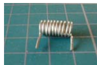
出来上がったコイルに 10pF を タップ 3 回目にハンダ付けする
